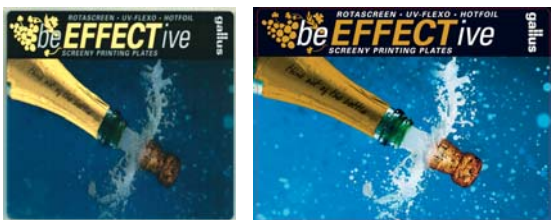
Abbildung 4: Etikett mit TubeLight aufgenommen (links), rechts PDF Vorlage.
